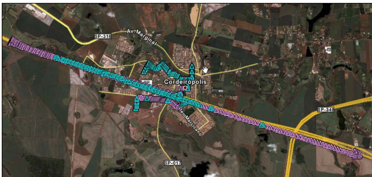
Figura 216 – Resultado do levantamento em mobilidade da cobertura digital de estação com características de RadCom, em Cordeirópolis
