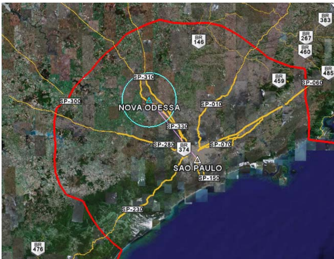
Figura 243 - Contorno protegido de Nova Odessa (830 kHz) e interferente de São Paulo (840 kHz)
