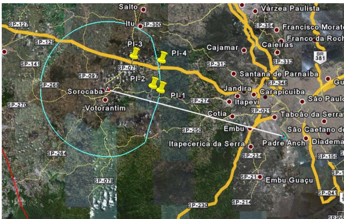
Figura 229 – Pontos onde foram realizados os testes da possível interferência do canal híbrido de 1200 kHz da Fundação Padre Anchieta, sobre a recepção do canal analógico de 1210 kHz, em Sorocaba
