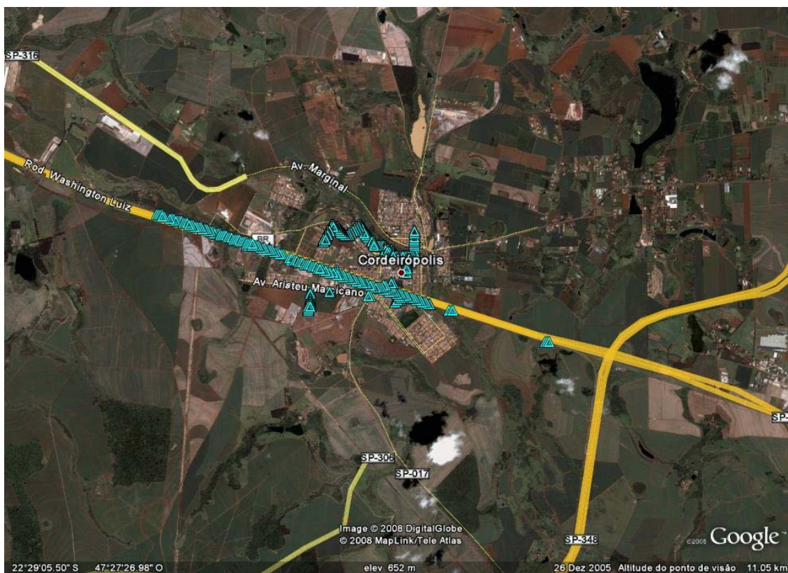
Figura 218 – Registros de recepção digital da estação com características de RadCom, em Cordeirópolis
