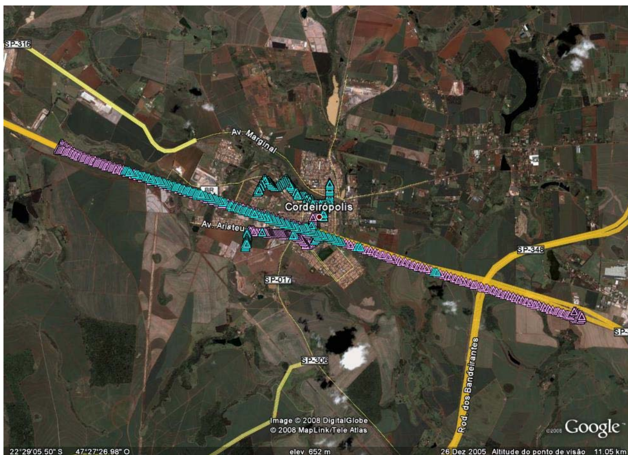
Figura 217 - Resultado do levantamento em mobilidade da cobertura digital de estação com características de RadCom, em Cordeirópolis
