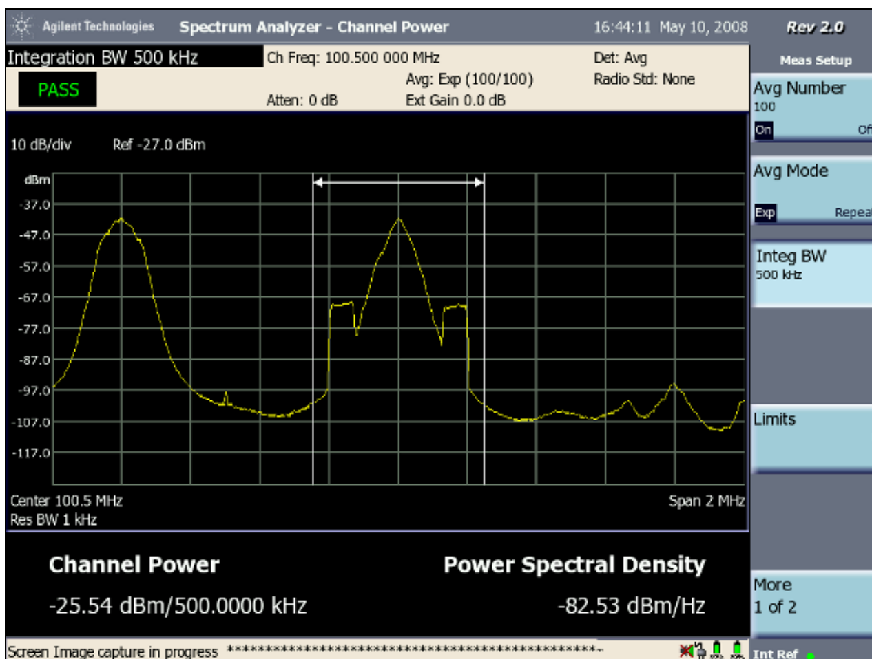
Figura 172 – Registro instantâneo do espectro do sinal híbrido do Sistema Clube, no Ponto 1 (sinal digital ligado)
