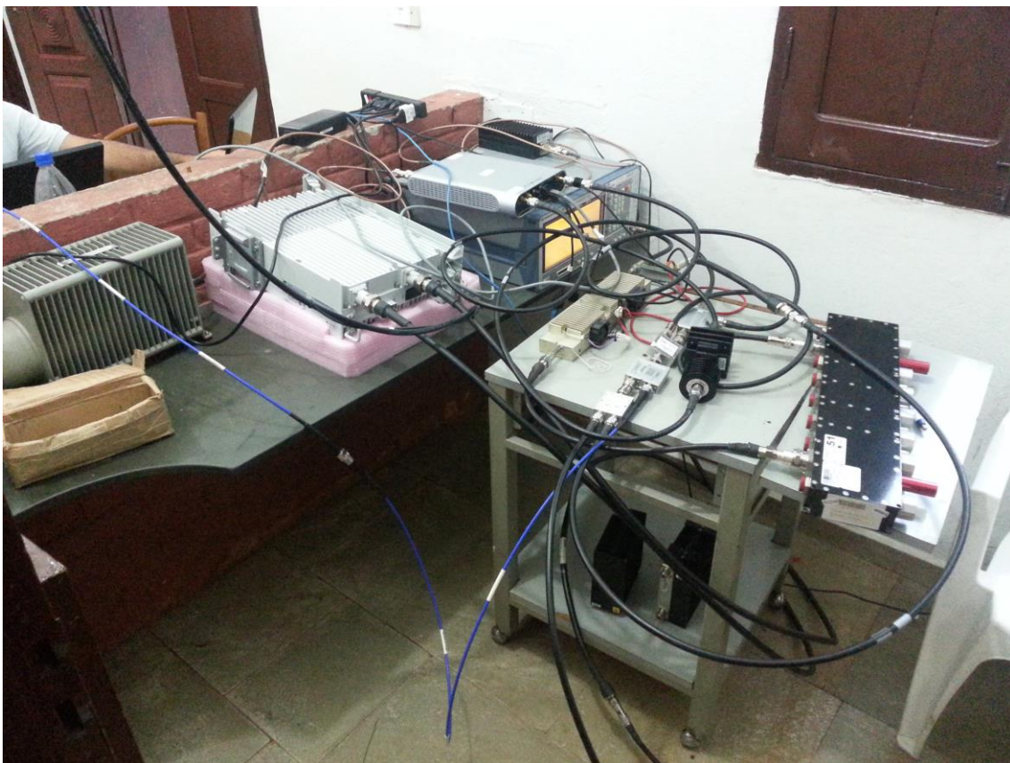
Figura 27. Setup de interferência TVD no LTE. Detalhe da ligação dos equipamentos.
