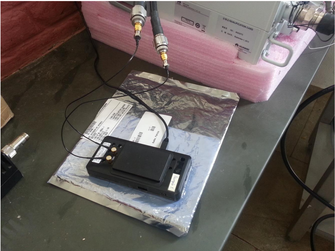
Figura 28. Detalhe da conectorização do terminal móvel utilizado (UE).
