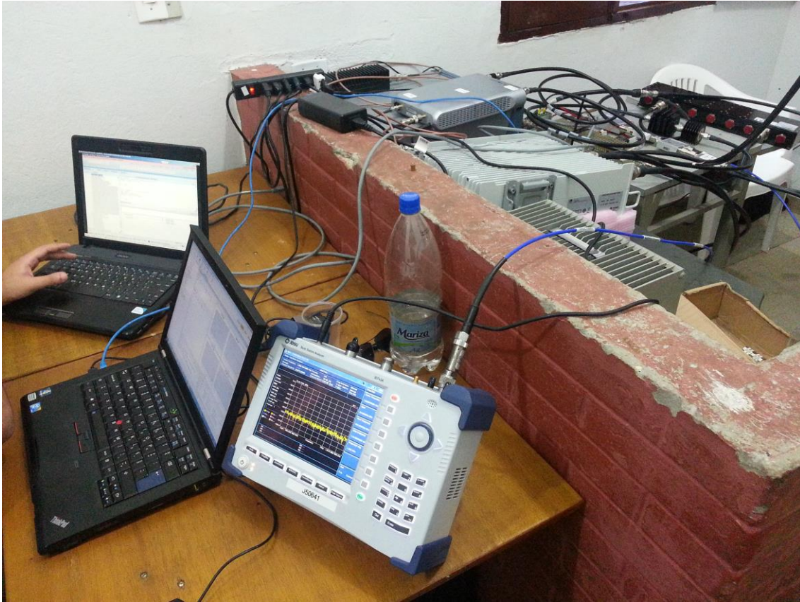
Figura 26. Setup de interferência TVD no LTE. Detalhe dos softwares de controle e do analisador de espectro utilizados.
