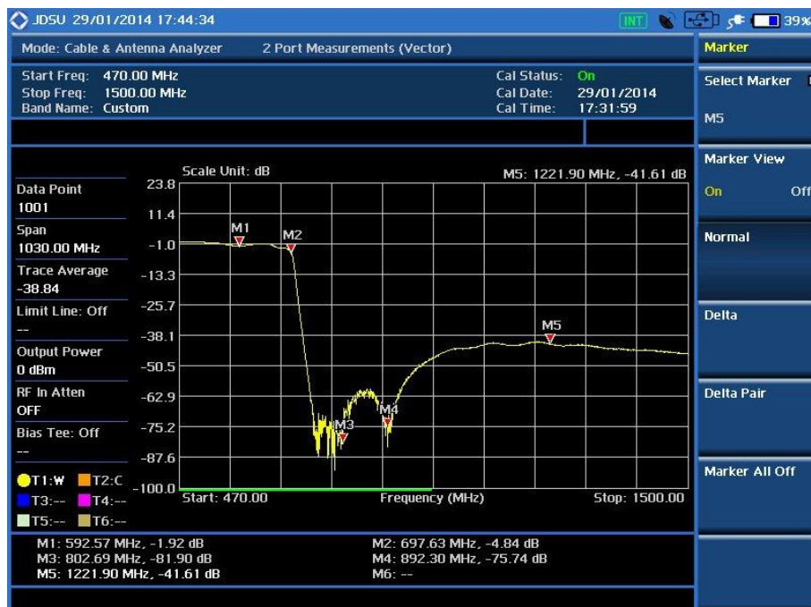
Figura 32. Resposta em frequência do filtro 1 utilizado no teste.
