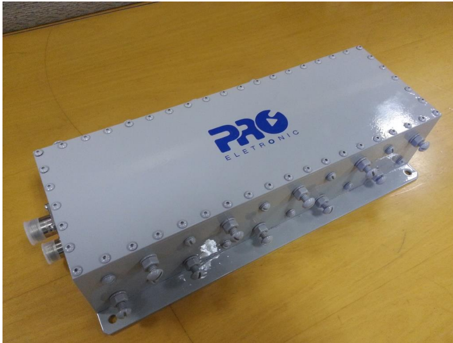
Figura 35. Filtro passa-faixa utilizado no teste.
