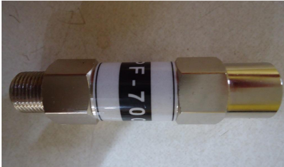
Figura 33. Filtro passa-baixa – filtro 2 utilizado no teste.
